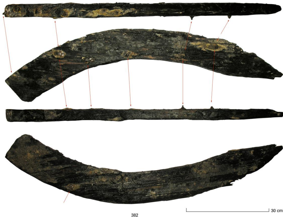
Figuur 90: V383. Vermoedelijk stuk scheepshout van zilverspar ( Abies alba ), de pijlen wijzen de verschillende ijzeren nagels aan.
