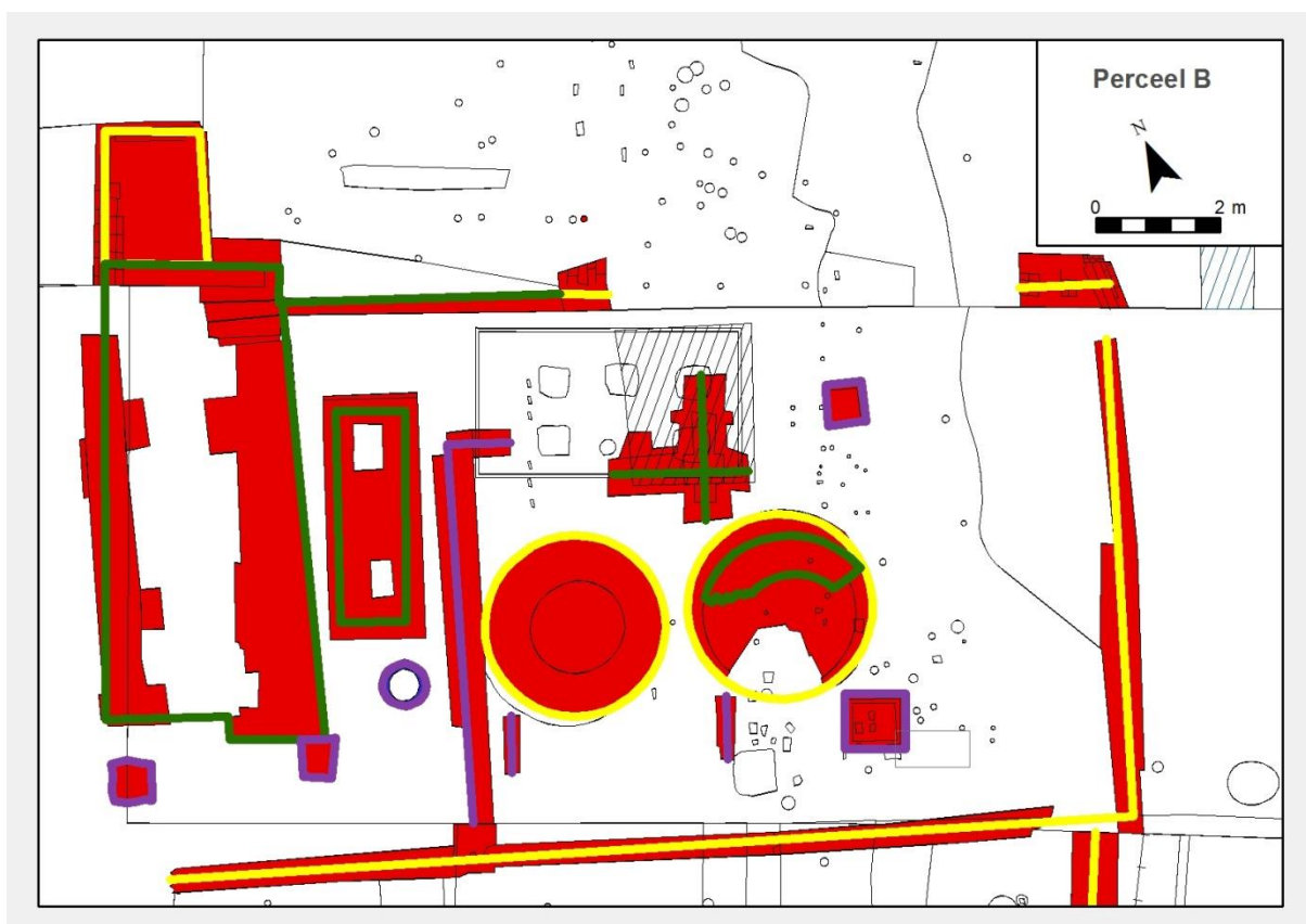
Figuur 22: Reconstructie van de kalkblusserij en de trasfabriek en de fasering binnen het muurwerk van deze twee gebouwen. Geel: oudste fase, groen: middelste fase, paars: jongste fase.
